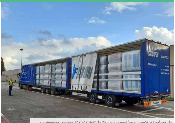
Les énormes camions ECO-COMBI de 25,5 m peuvent livrer jusqu'à 30 palettes de laine minérale de verre de Knauf Insulation, permettant de transporter le même volume de produits en utilisant 30% de remorques standard en moins, réduisant les émissions de CO, d'environ 20%.
